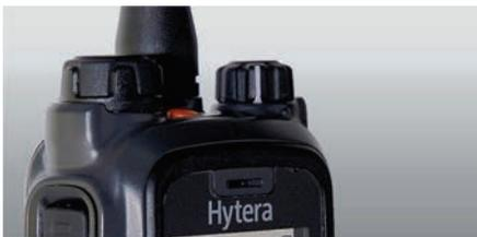
El PT580H cuenta con un diseño industrial patentado en todo el mundo: la antena, que se encuentra en la posición media, proporciona un patrón omnidireccional para lograr un mejor rendimiento de cobertura y cuenta con GPS integrada. Las perillas giratorias, que se encuentran separadas por la antena y tienen distintos tamaños, facilitando el acceso a la perilla de volumen y a la de selector de canal.
