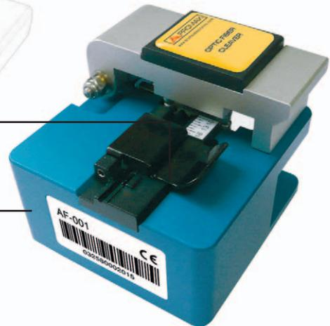
Diseño compacto, ligero y robusto. Ideal para aplicaciones en campo FTTx. Para fibras de diámetro 125  $\mu$ m. Vida útil de la cuchilla de unos 12.000 cortes. La sujeción de la fibra se realiza mediante resortes asegurados con imanes.
