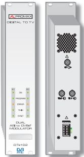
Genera una salida DVB-T (compatible con la TDT) a partir de las dos entradas *Transport Stream ASI* (secuencia de datos digital).
