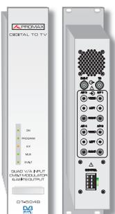
El módulo DT-504B es capaz de generar una salida en formato DVB-T a partir de cuatro entradas de vídeo y audio analógicas. Está formado por cuatro codificadores MPEG-2 independientes de vídeo y audio, un multiplexor y un modulador.
