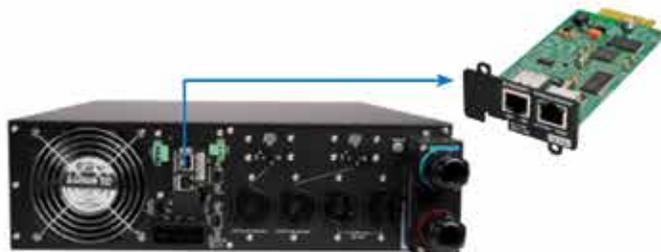
La Tarjeta de Red MS permite al 9PX conectarse con una red Ethernet y con Internet, dando soporte a un monitoreo y control en tiempo real del UPS a través de la red por medio de un navegador Web estándar, un sistema de administración de red en cumplimiento con SNMP o con software de administración de energía.
